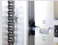
Rouleaux avec roulements à rouleaux scellés
