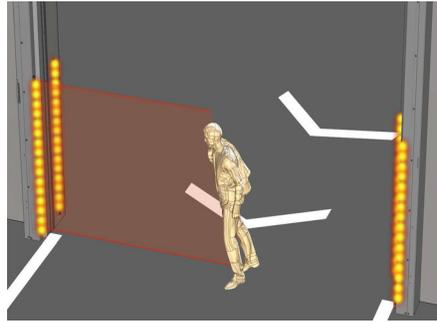
Réduction de la vitesse d'ouverture/de fermeture des portes si les faisceaux sont bloqués, ou si des schémas de circulation anormaux ou une présence inhabituelle dans les portes sont détectés.
