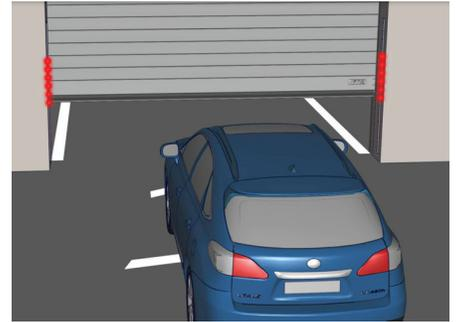
Rouge en cascade dans le sens du mouvement lorsque la porte s'ouvre ou se ferme.
