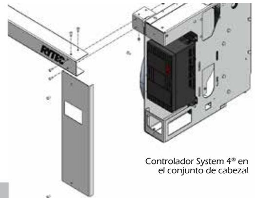
Controlador System 4® en el conjunto de cabezal
