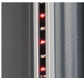
Les lampes rouges s'allument pour indiquer que la porte se ferme
